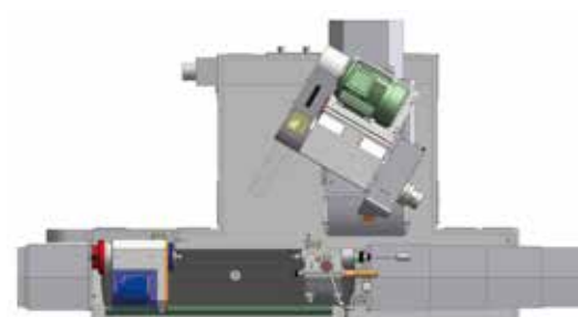
EGP-A — 直進斜砂 最大研磨直徑：360~480mm 兩頂心距：600~2000mm
